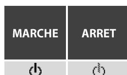
Si la zone se trouve dans le mode ARRET parce qu'une fenêtre prévue d'un contact de fenêtre a été ouverte, l'icône suivante sera montrée:
