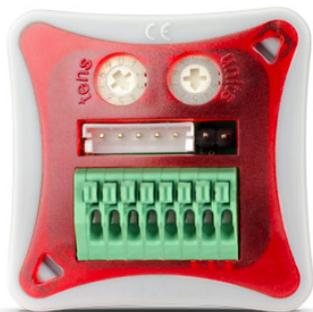
Interface d'entrée miniature avec une entrée analogique universelle et une entrée numérique.
