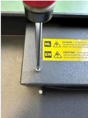
Retirez le capot de protection de l'alimentation en dévissant les deux boulons M3 avec un tournevis étoile
