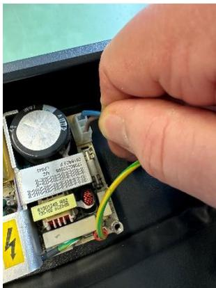
Tirez délicatement sur le connecteur d'alimentation 230V ainsi que sur la connexion de mise à la terre du PCB à droite.
