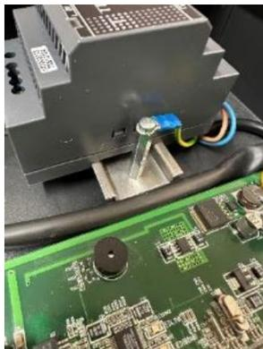
Appliquez un œil de sertissage (type bleu) sur le fil de terre et connectez-le sur la douille d'espacement en acier inoxydable et fixez-le avec le boulon M3 avec rondelle de blocage
