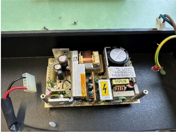
Dévissez maintenant les deux entretoises en acier inoxydable (30 mm) en les tournant dans le sens inverse des aiguilles d'une montre avec une clé plate ou une clé à douille.
