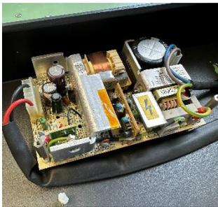
Vous pouvez maintenant voir l'alimentation à remplacer par la connexion à l'entrée 230VAC + la mise à la terre à droite et la sortie 12V à la carte MICROS à gauche
