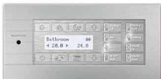
La fenêtre tactile TELETASK LATUS est une interface AUTOBUS pour la commande aisée du chauffage/de la climatisation et de la gestion de diverses fonctions domotiques. Parmi les seize touches, huit touches sont pré-réglées pour des fonctions de thermostat, mais elles restent, tout comme les huit autres touches, librement réglables.
