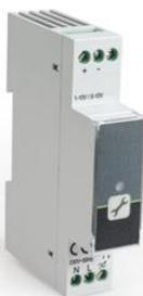
Ce variateur de puissance universel 350 W est conçu pour un montage sur rail DIN et il a une taille de 1 module. Ce variateur de puissance est conçu pour la variation des lumières traditionnelles, des transformateurs électroniques et des éclairages LED. Le variateur a un signal d'entrée de 0-10V et accepte une alimentation 230V 50Hz (variation par coupure de début ou de fin de phase, définie par des switches sur le variateur de puissance).
