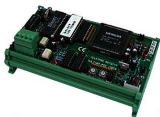
Interface pour relier un système de sécurité GALAXY (type 8, 18, 60 ou 500) ou GALAXY series G3 ou GALAXY DIMENSION de Honeywell au système de TELETASK. Cette interface permet d'employer les détecteurs de mouvement du système de sécurité pour commander des fonctions de domotiques.
