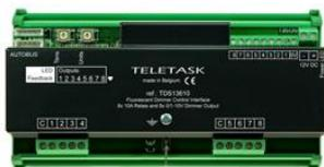
L'interface variateur fluorescence TDS 13610 dispose de 8 sorties analogiques 1-10V pour la commande de lampes à fluorescence dimmables. L'interface dispose aussi des sorties à contact nécessaires pour la commande de la tension vers les armatures à fluorescence dimmables.
