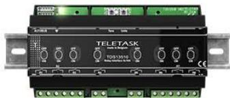
Interface relais avec huit relais de puissance unipolaires de 16A / 250V. Chaque relais dispose de sa propre commande manuelle. En cas de panne de courant, ou lorsque la centrale domotique est arrêtée, l'utilisateur peut ouvrir ou fermer le contact du relais sur l'interface. Suite au retour du courant ou à l'activation de la centrale, le système reprend automatiquement le contrôle des relais selon les réglages définis.
