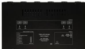
4-canaux, 0-10V variateur de puissance contrôlable 4 x 1000VA pour atténuer des charges résistives et inductives et des triacs transformateurs électroniques atténuants (LED,...). Montage sur mur plan. Le variateur est conçu pour une tension de réseau de 230V/50Hz.
